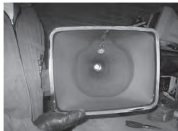
Ilustración 68: "Getterpill" en el cono. Foto: MAVDT
