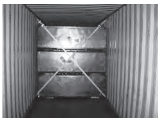
Ilustración 17: Asegurar que la carga esté bien sujeta durante el transporte. Foto: MAVDT
