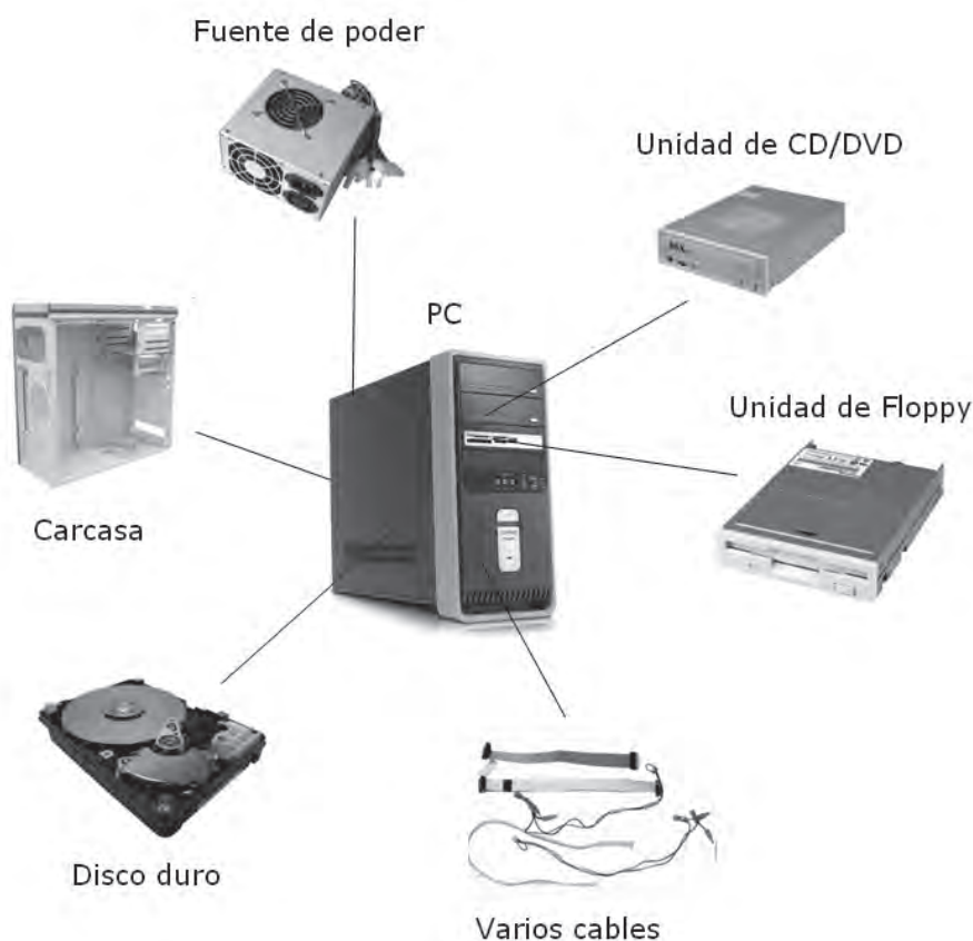
Ilustración 38: Un computador de escritorio y sus principales componentes.
