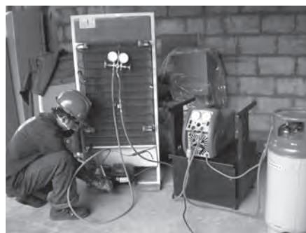
Ilustración 30: Descontaminación de neveras. Foto: MAVDT
