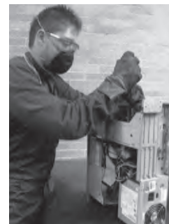
Ilustración 37: Desensamble manual de un equipo electrónico. Foto: MAVDT
