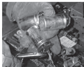
Ilustración 78: Cortar los cables de los condensadores. Foto: eag-leitfaden.
