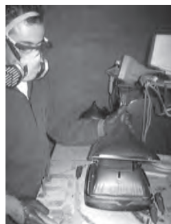
Ilustración 63: Separar el tubo de imagen. Foto: MAVDT.
