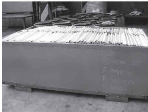
Ilustración 92: Contenedor seguro para el transporte de tubos fluorescentes. Foto: MAVDT.
