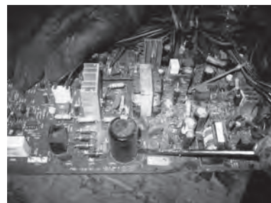
Ilustración 76: Destornillar de un condensador. Foto: MAVDT
