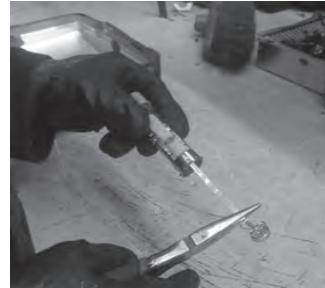
Ilustración 54: Separar los "getterpills". Foto: MAVDT
