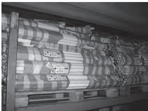
Ilustración 91. Almacenamiento de tubos fluorescentes en estibas. Foto: MAVDT
