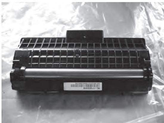
Ilustración 59: Cartucho de tóner con tambor fotoconductor.
