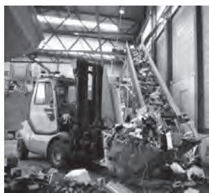
Ilustración 32: Equipo de alimentación de un triturador de RAEE. Foto: http://ewasteguide.info
