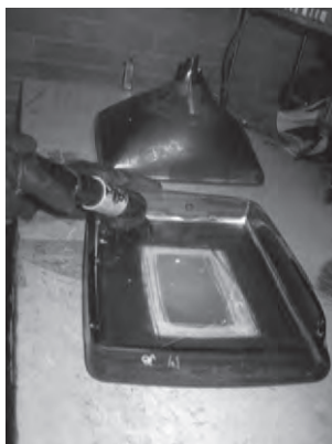
Ilustración 65: Aspiración del recubrimiento. Foto: MAVDT
