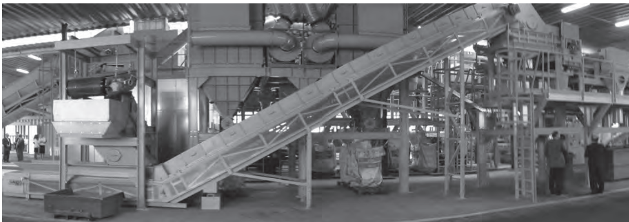
Ilustración 31: Trituradora de cadena para los RAEE. Foto: Global Electric Electronic Processing GEEP.
