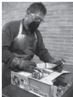
Ilustración 36: Desensamble manual de un computador. Foto: MAVDT
