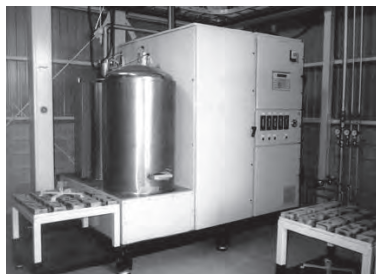
Ilustración 93: Modelo de planta pequeña de reciclaje de lámparas fluorescentes. Foto: www.gec.jp/JSIM_DATA/WASTE/WASTE_2/html/Doc_382.html
